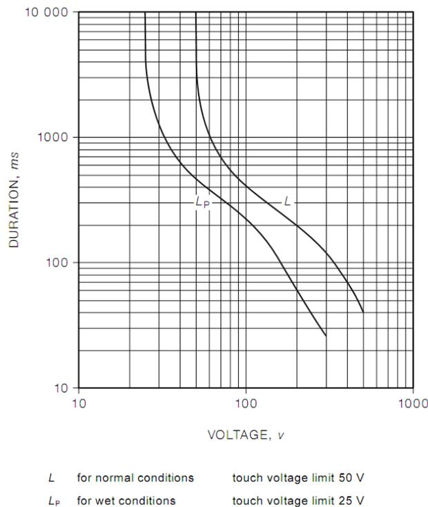
FIGURE C1 MAXIMUM DURATION OF PROSPECTIVE 50 HZ TOUCH VOLTAGE
